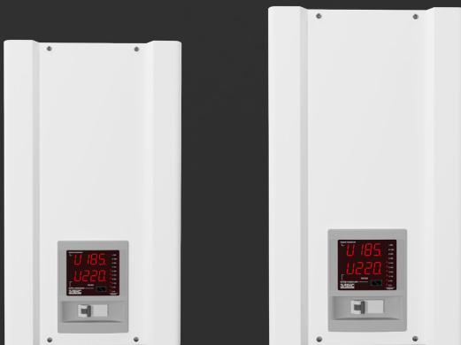
**Однофазный стабилизатор напряжения Ампер 9** предназначен для работы в электрических сетях с колебаниями напряжения от 160 до 260В. В этом диапазоне аппарат выдает на выходе напряжение в рамках 220В±4.5%, что обеспечивается за счет использования 9 ступеней стабилизации.
